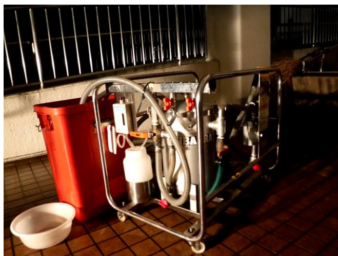
濾過浄水器の点検
